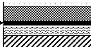
Der Fußbodenaufbau im Untergeschoss ist identisch, er weist zusätzlich eine Abdichtung auf der Bodenplatte auf.
