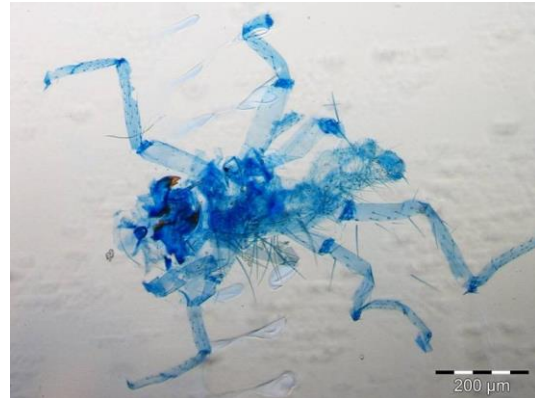
Abb. 5: Mikroskopie einer Folienkontaktprobe und Nachweis einer Staublaus
