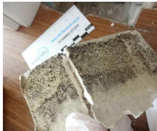
Abb. 6 und 7: Braun-graue bis schwarz-graue Verfärbungen an Wandoberflächen sind auf Schimmelschäden zurückführbar
